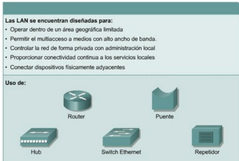
Figura 2. Componentes de la red de área local.
