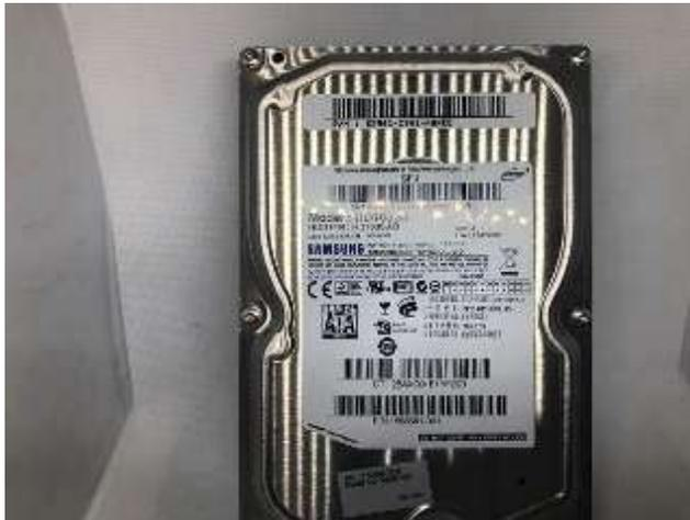
En caso de un golpe o sobrecalentamiento es un indicador de cambiar el disco duro siendo de los componentes más sencillos de reemplazar.
