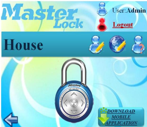
Al seleccionar una cerradura, el sistema mostrara una pantalla de acceso a esta, la cual muestra en la parte superior derecha las opciones de editar usuarios, editar la red a la que está conectada la cerradura y la de ayuda, y en la parte inferior derecha la opción para descargar la aplicación para teléfono celular que permita acceso a esta única
