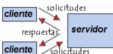
Figura 2.1 Modelo Cliente Servidor
