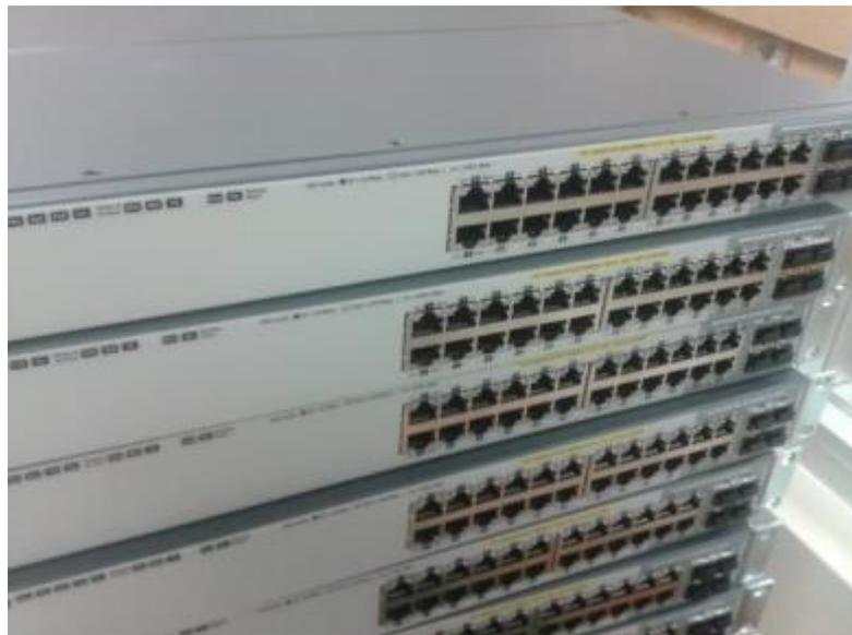
Figura 4.20 Switches HP, con POE (Power Over Ethernet) incluido
