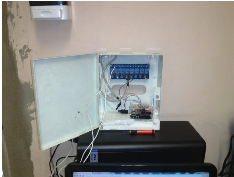
Figura 9.8.2: circuito conectado a cerradura eléctrica
