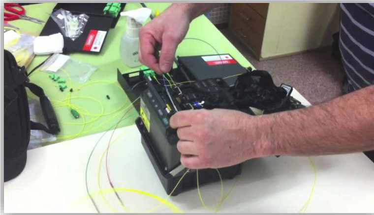
Figura 4.15 – reparación de fibra óptica.
