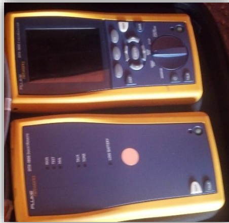
Figura 3.2 – Cable Analyzer, Analizador de cables.
