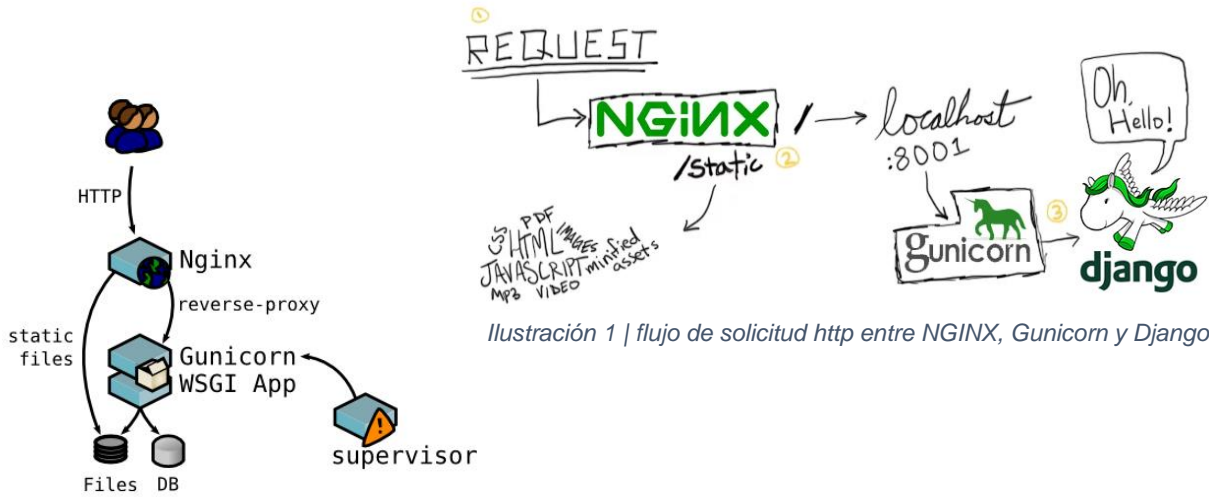
Ilustración 2 | NGINX y Gunicorn como WSGI Gateway
