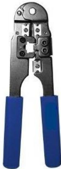
Figura 3.5 – Ponchadora de conector RJ45
