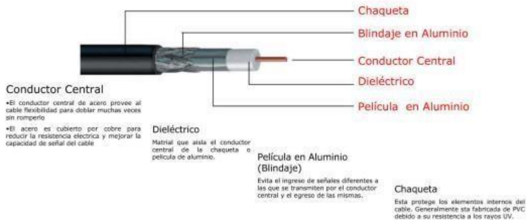
Figura 3.6 Cable coaxial, uso para grandes distancias.
