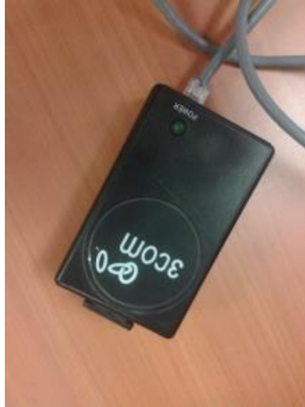
Figura 4.21 Adaptador 3COM, Energía alterna para conexión de teléfonos IP
