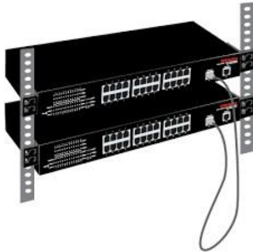
Figura 3.3 Trunking entre 2 switch, conectados por cross over
