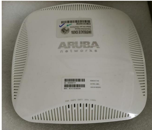
Figura 4.9 Access Point ARUBA (AP), Punto de Acceso Inalámbrico
