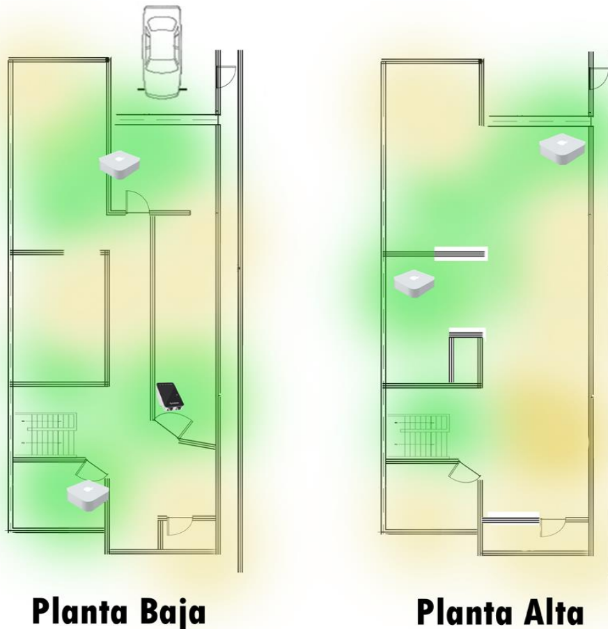
Fig. 5- Instalación de Accesorios de Punto de Acceso en la empresa.
