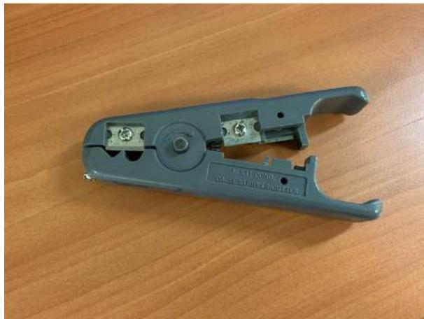
*Figura 5.10 – Peladora de Cables*
